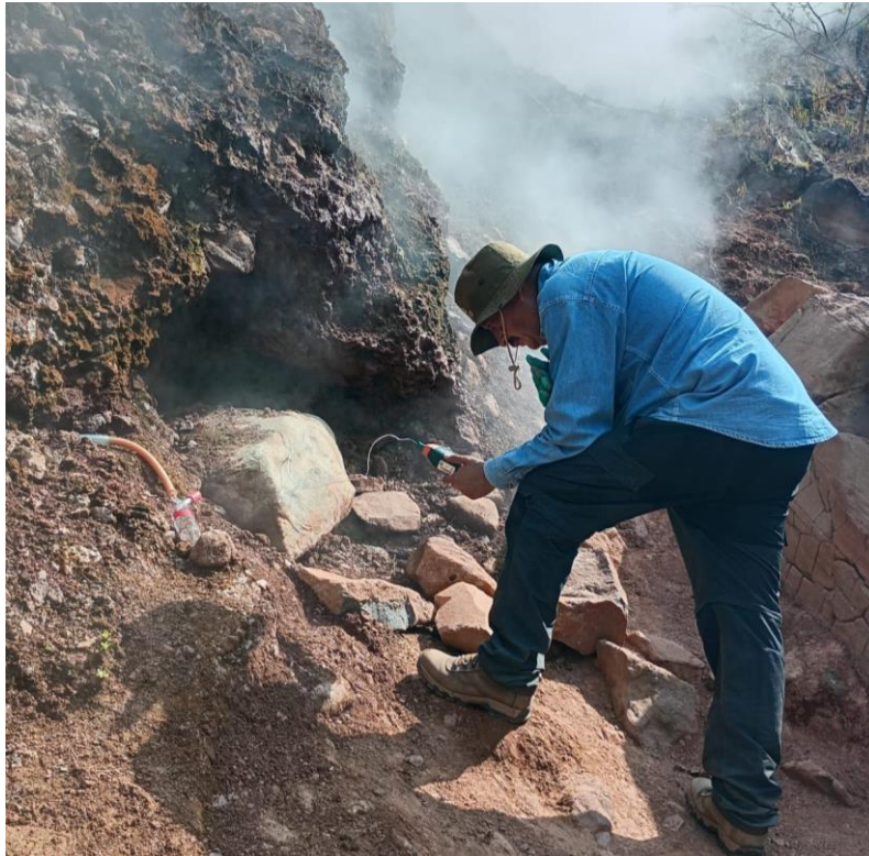
Toma de datos termométricos de la fumarola principal de vapor y gas del volcán Ceboruco, en el estado de Nayarit, el cual tuvo su última erupción en 1873
