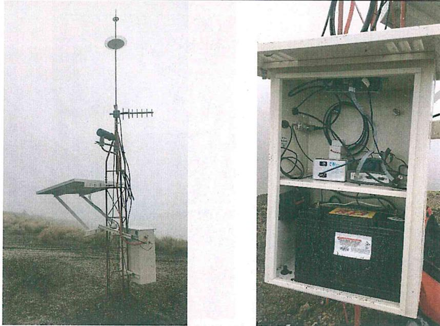
Figura 6. Se muestra la estación PPX instalada en sitio y la vista del interior del gabinete con el equipo DOAS.
