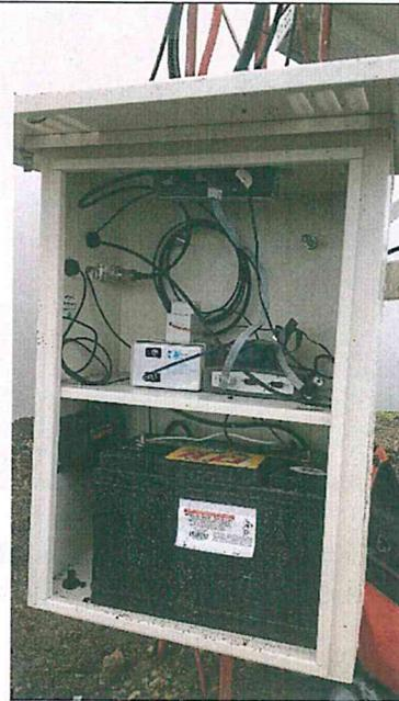
Figura 6. Se muestra la estación PPX instalada en sitio y la vista del interior del gabinete con el equipo DOAS.
