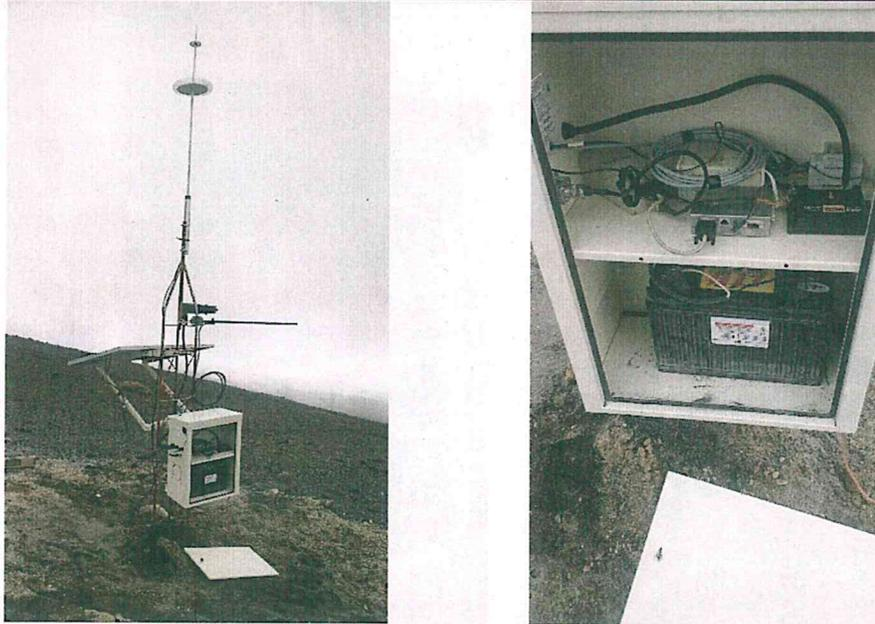
Figura 7. Se muestra en las imágenes la estación levantada en Juncos, así como el equipo DOAS dentro del gabinete.
