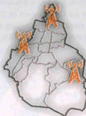
Figura 6. Esquema de los tres transmisores TxSARMEX para difundir la señal de alerta sísmica del SASMEX en la Ciudad de México.
