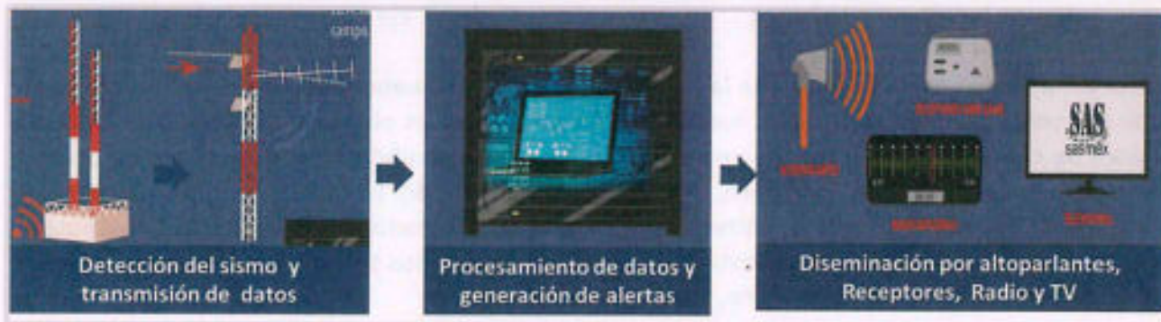
Figura 1. Esquema funcional del SASMEX®
