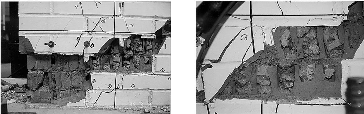
**Figura 3.6 - Condición final de daño (castillo Este)**
