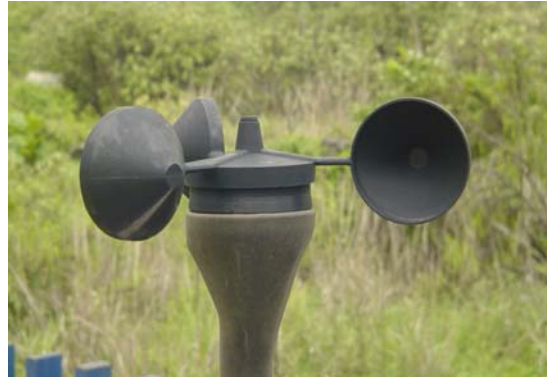
Figura 2.4 Instrumento para medir la velocidad del viento (anemómetro)
