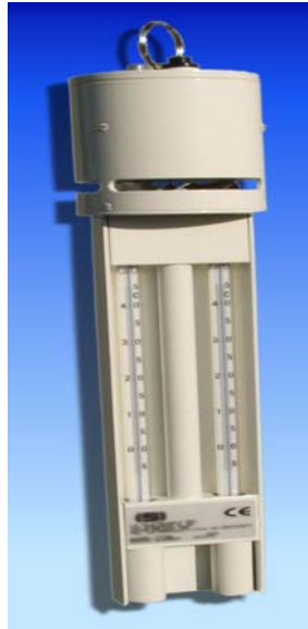
Figura 3.14 El psicrómetro es el aparato que permite medir la humedad relativa del aire
