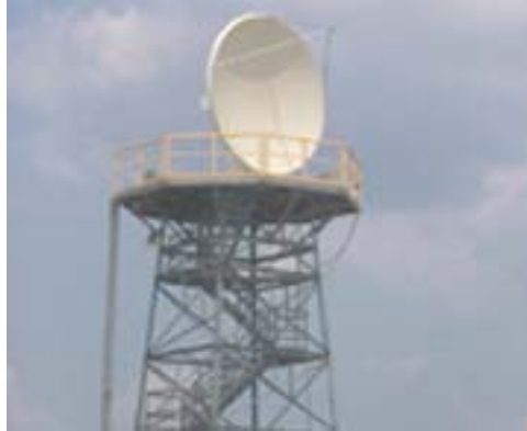
Figura 3.13 Radar meteorológico tipo Doppler
