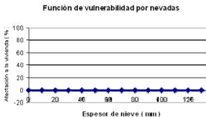
Figura 3.61 Función de vulnerabilidad para casas con techos de losa de concreto
