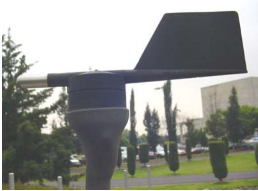
Figura 2.3 Aparato para obtener la dirección del viento (veleta)
