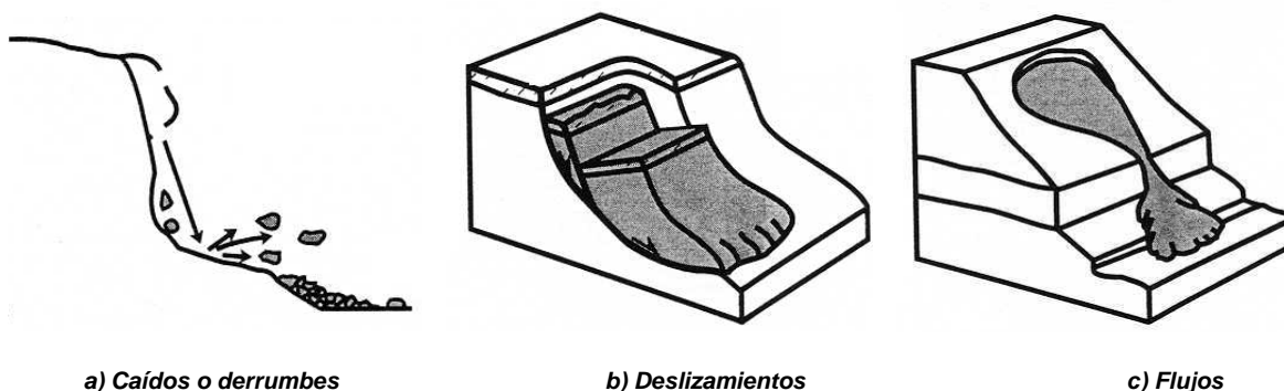
Figura 5.1 Principales tipos de deslizamientos en laderas
