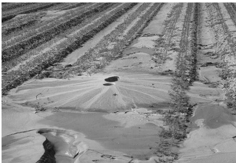
Figura 1.5- Volcán de arena en un campo de cultivo, evidencia de licuación
