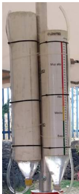
Pluviómetros caseros con escala para definir niveles de alertamiento, según la lluvia registrada
