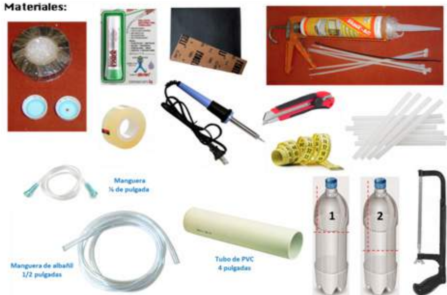
Materiales para la fabricación de pluviómetros caseros
