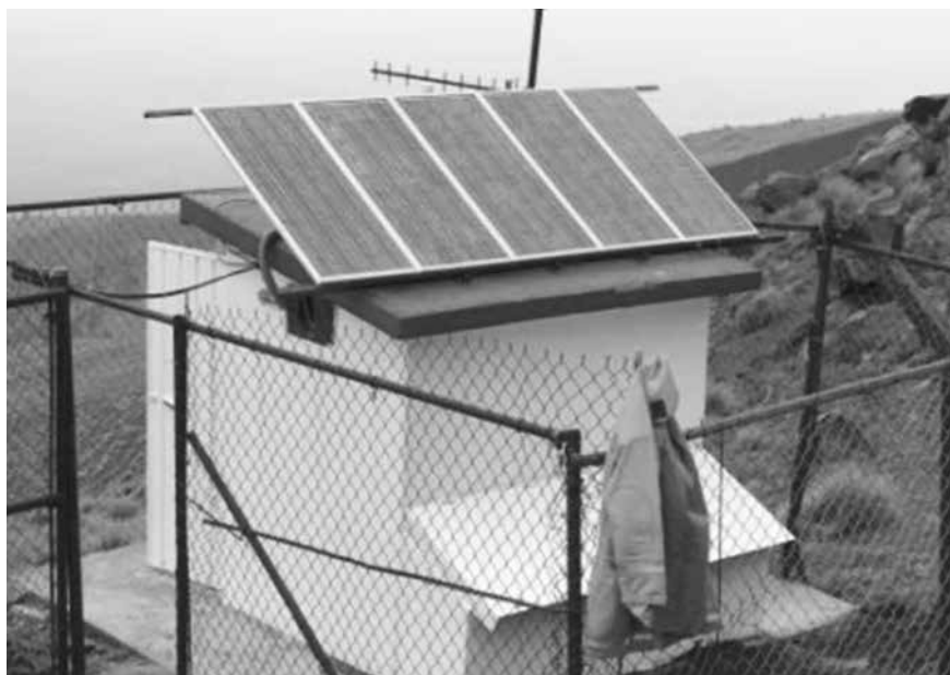
Figura 4. Estación sismológica Canario, instalada en el Popocatépetl. Forma parte de la red de monitoreo que opera actualmente en el volcán.
