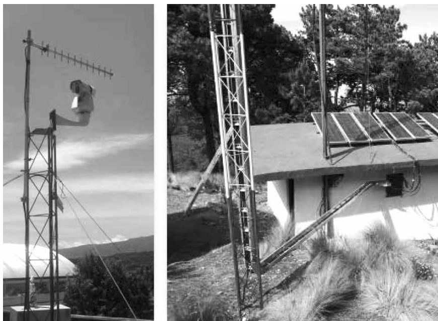
Figura 5. Ejemplo de estaciones de monitoreo visual instalada en el Popocatepetl y que forma parte de la red de monitoreo que opera actualmente en el volcán. A la izquierda, cámara instalada en Tianguismanalco, Puebla, a la derecha, estación de observación instalada en el cerro de Tlamacas, aproximadamente a 5 km al norte del volcán.
