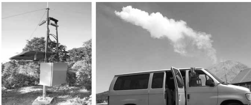
Figura 8. A la izquierda se muestra una estación de monitoreo geoquímico instalada en el Popocatépetl, a la derecha se muestra una imagen de una campaña de adquisición de datos para la cuantificación de gases emitidos por el volcán; ambos forman parte del sistema de monitoreo que opera actualmente en el Popocatépetl.
