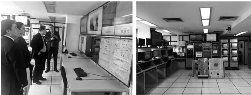
Figura 3. Laboratorio de Monitoreo de Fenómenos Naturales (CENAPRED) en donde se reciben, teleméricamente, las señales que pertenecen a la red de monitoreo volcánico del Popocatépetl. Adicionalmente se reciben y analizan señales de otros fenómenos naturales que aquejan al país (otros volcanes en México, sismos, fenómenos hidrometeorológicos y clima espacial).
