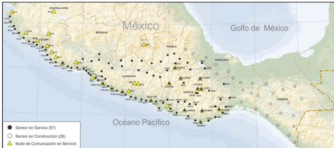
Figura 3.2. Redes de estaciones que forman al Sistema de Alerta Sísmica Mexicano, SASMEX. Fuente: http://www.cires.org.mx/sasmex_es.php
