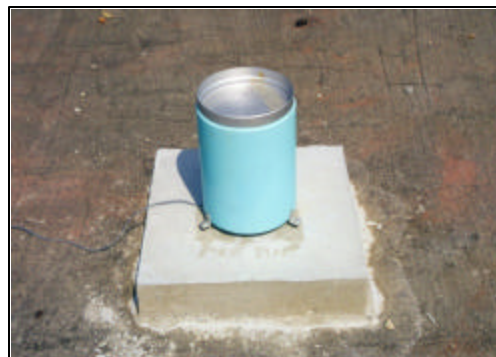
Figura 3.10 Pluviómetro (Tipo 2) instalado sobre una base de concreto
