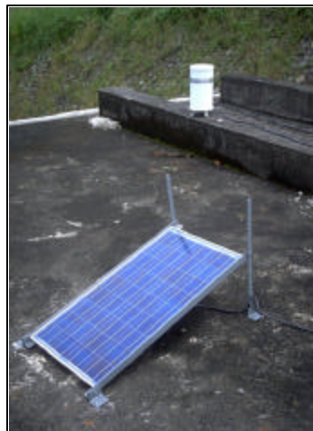
Figura 6.10 Pluviómetro y celda solar, estación La Presa
