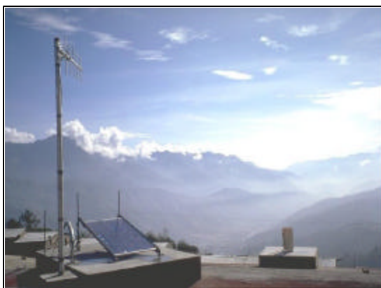
Figura 5.4 Pluviómetro, celda solar y antena de radio, estación Las Cruces, CR-02
