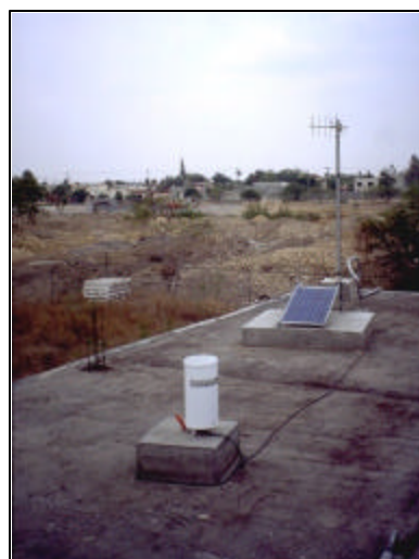
Figura 7.7 Pluviómetro, celda solar y antena de radio, estación Ciudad Universitaria, CU-03
