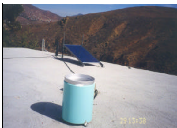
Figura 4.8 Pluviómetro y celda solar, estación La Presa
