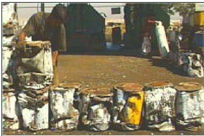
Figura 5.7 Cilindros de gas LP destruidos
