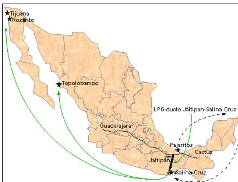
Figura 5.3 Terminales marítimas y ducto de gas LP de 12" dn Jáltipan – Salina Cruz (Ibarra, 1997).
