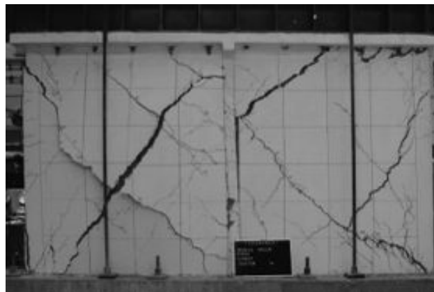
Patrón final de daño en un modelo de muro reforzado con mortero y fibra metálica
