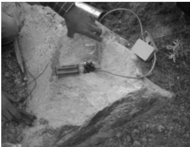
Instalación de geófono y digitalizador.
