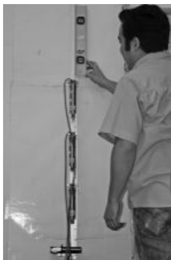
Calibración de inclinómetros de cuerda vibrante GEOKON en el LDS del CENAPRED
