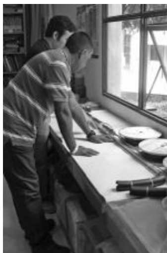
Calibración de inclinómetros de cuerda vibrante GEOKON en el LDS del CENAPRED
