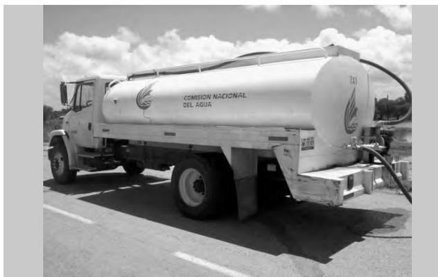
**Figura 2.415 Equipo para abastecimiento de agua potable**
