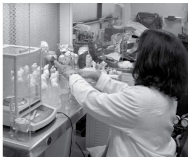
Preparación de muestras para evaluar el tratamiento biológico de un suelo contaminado con el plaguicida DDT
