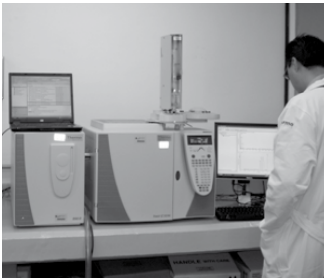
Determinación de plaguicida por cromatografía de gases acoplada a masas
