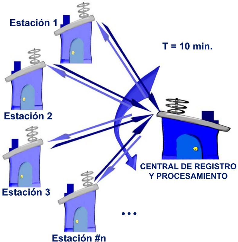
El puesto central se encarga de interrogar a cada una de las estaciones remotas a intervalos fijos de 10 minutos, así como de almacenar la información. Los análisis se comparan con un umbral preestablecido, para determinar si se activa o no la alarma local que dé aviso al personal encargado de la supervisión del sistema, presente en pantalla resultados y genere gráficas, con el objeto de mantener informadas del fenómeno meteorológico a otras instituciones.
