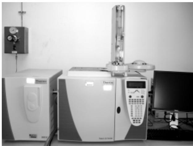
Cromatógrafo de gases acoplado a espectrómetro de masas
