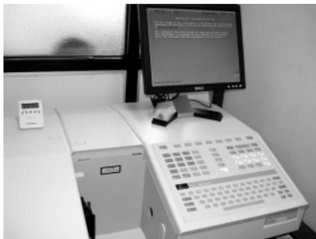
Espectrómetro de Infrarrojo por Transformada de Fourier
