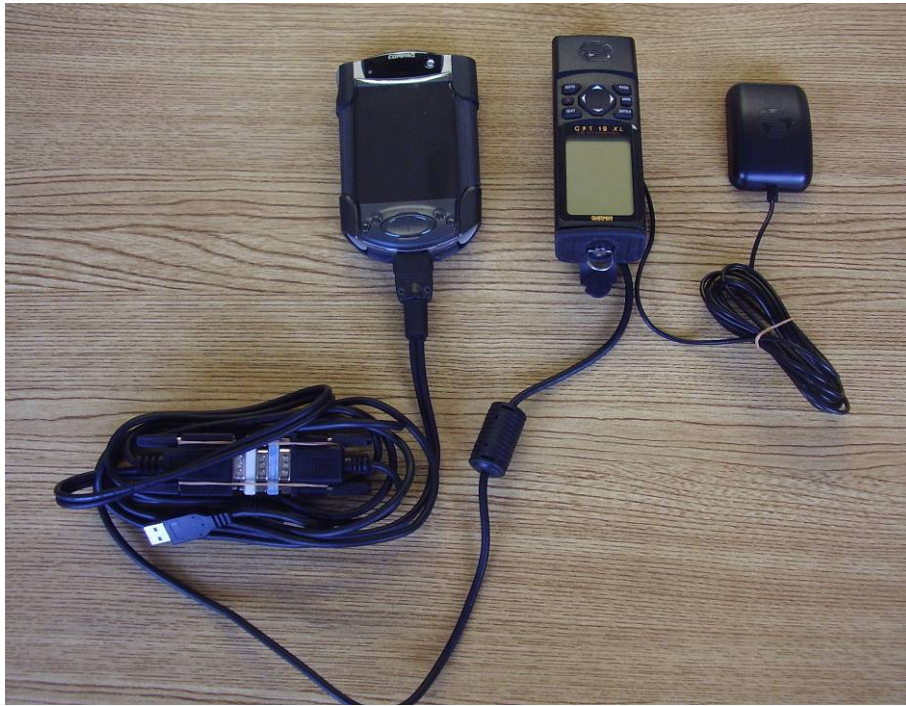
Figura 3.3 Equipo Mapa Móvil utilizado en los trabajos de campo
