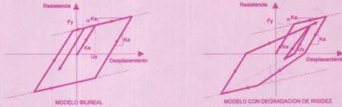
Modelos histeréticos empleados: (a) modelo bilineal; (b) modelo con degradación de rigidez
