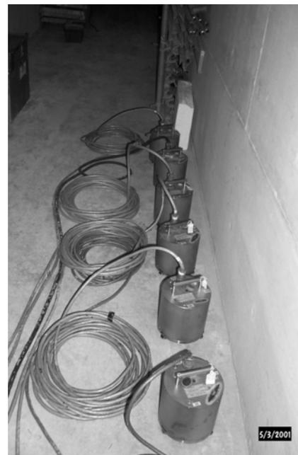
*Sensores de la Red Sísmica Portátil del CENAPRED*
