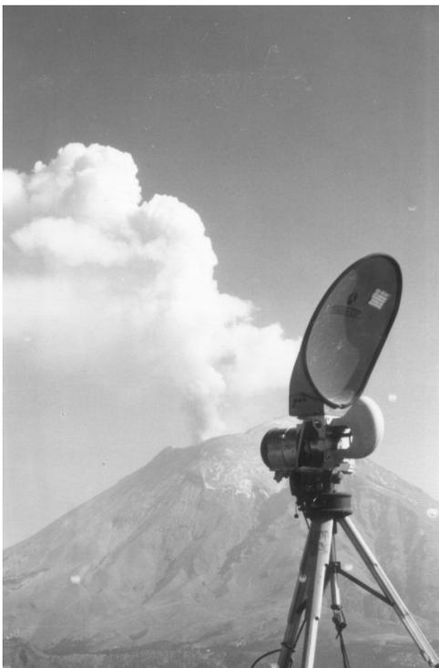
*Antena de microondas para la transmisión de la imagen del Volcán Popocatepetl en tiempo real al CENAPRED*
