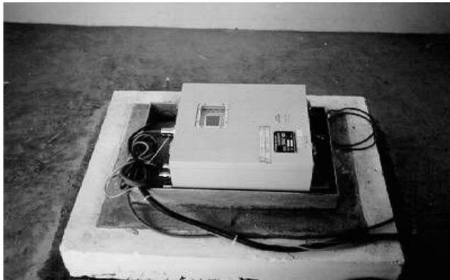
*Acelerógrafo instalado en el edificio del Instituto Mexicano del Petróleo*
