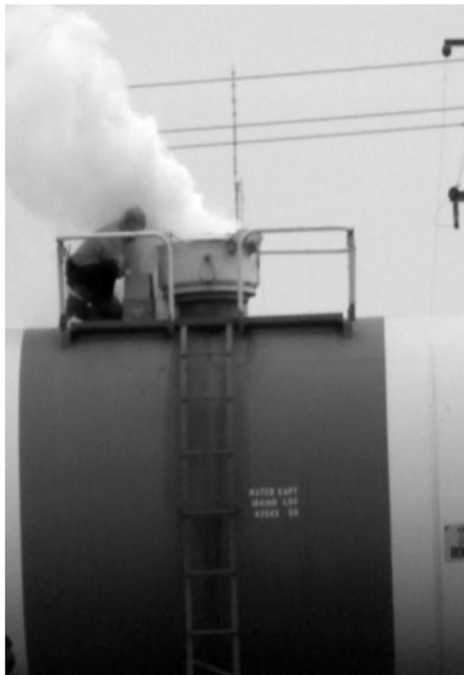
Asistencia para control de fuga química en un carrotanque
