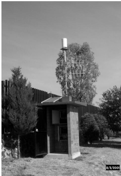
*Estación Pluviométrica y de Nivel, instalada en el CENAPRED*
