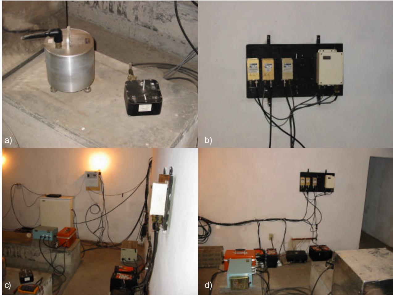
**Vista interior de la caseta de Tlmacas: a) sensor sísmico y acelerómetro, b) radios de telemetría c) y d) vista general de los equipos**
