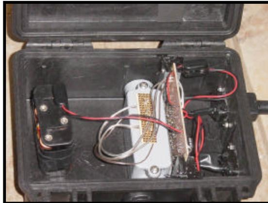
**Figura 3.31** Sensor infrasónico instalado en el volcán Popocatepetl
