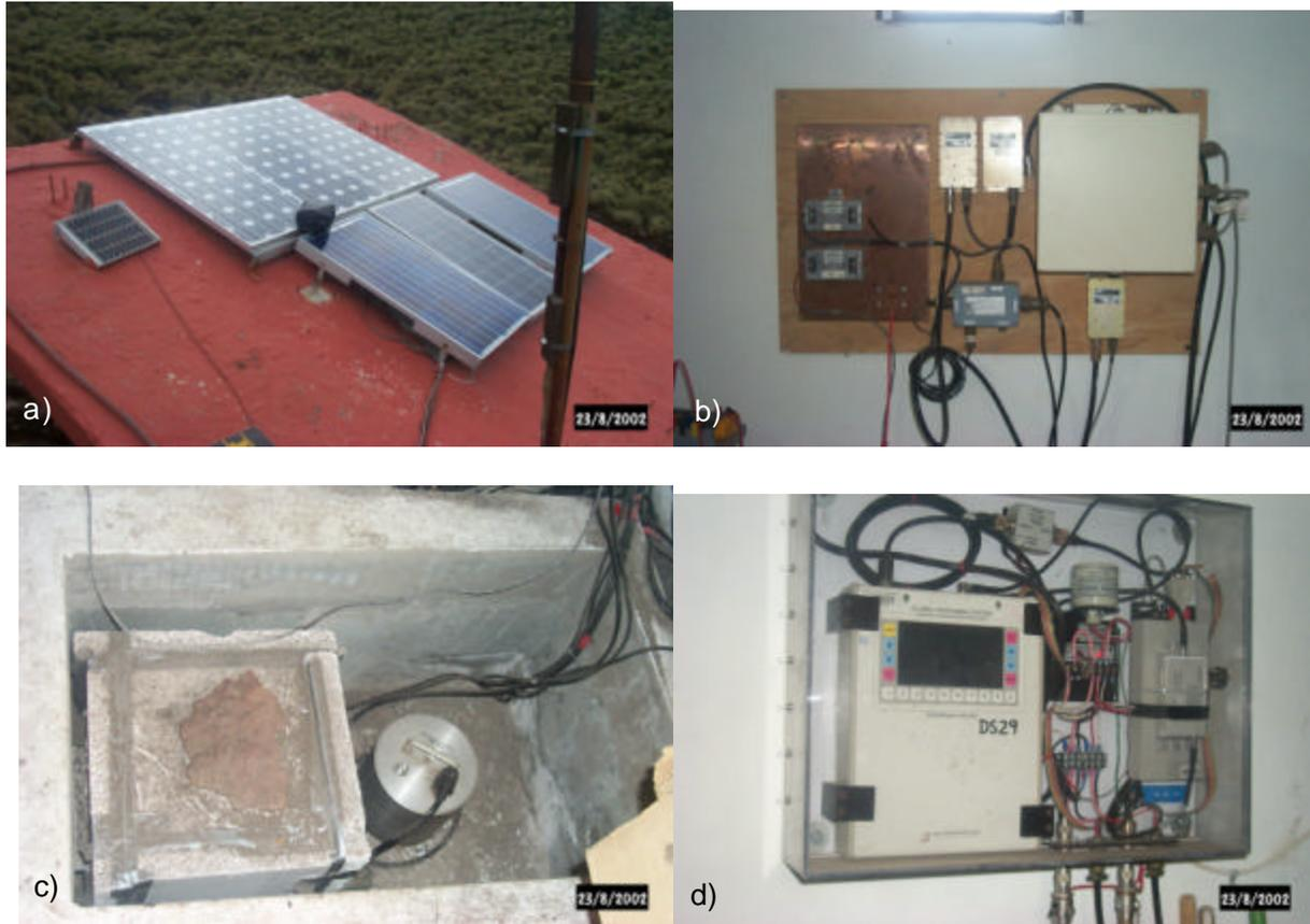
*Vista interior de la caseta de Chipiquixtle: a) celdas solares, b) radios de telemetría y equipo acondicionador
