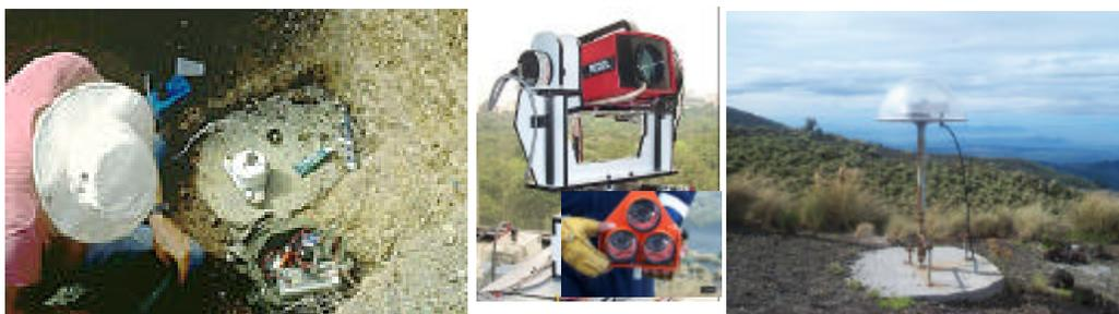
**Figura 3.15 Instrumentos empleados para la medición de deformación: Inclinómetro (izquierda), distanciómetro electrónico (centro) y GPS (derecha)**
