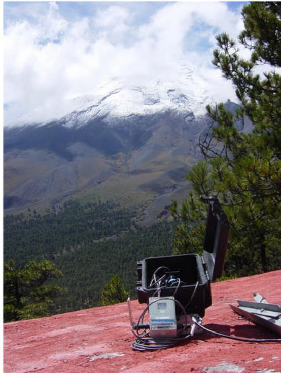
**Figura 3.32** Sensor térmico o radiómetro instalado en el volcán Popocatepetl
