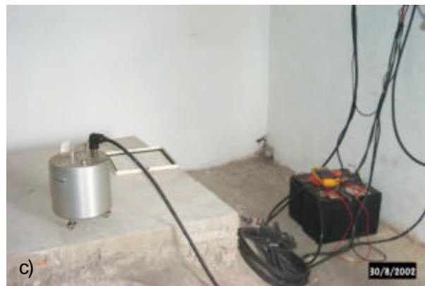
*Vista interior de la caseta de Colibri: a) equipo acondicionador, b) y c) sensor sísmico*
