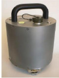
**Figura 2.3 Sismómetro triaxial (CMG-40T)**
