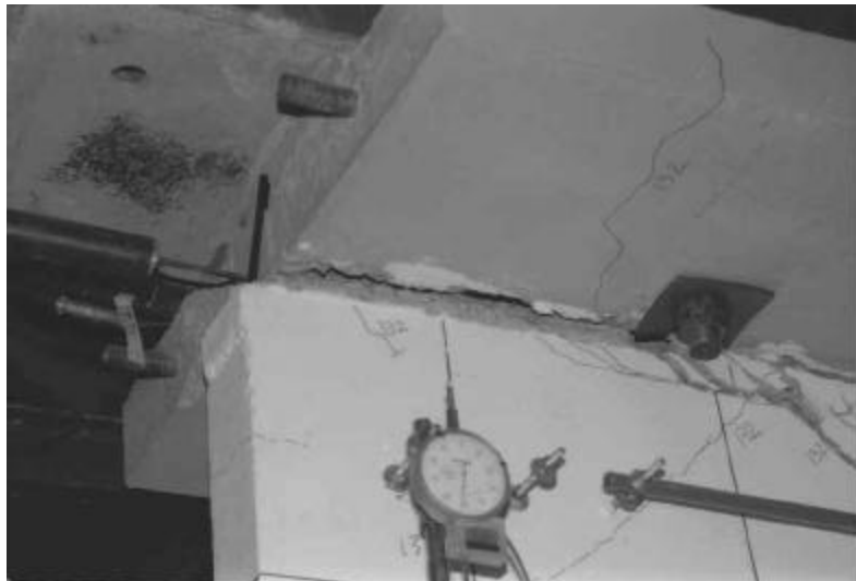
Figura 3.18 Modelo M-250: Detalle del cortante de entrecara entre la losa y el muro, en la esquina superior Este
