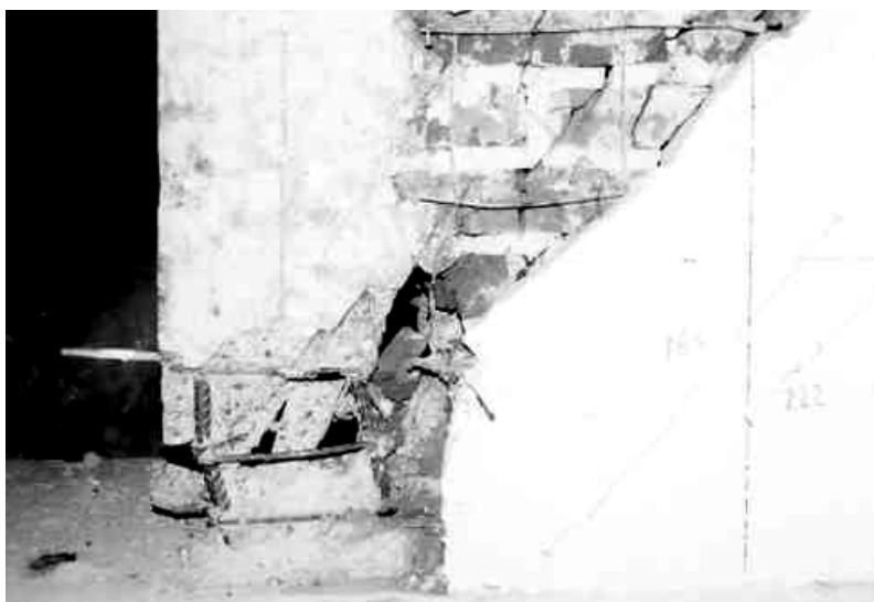
Figura 3.28 Modelo M-072: detalle del flexionamiento del refuerzo longitudinal en la base del castillo Oeste
